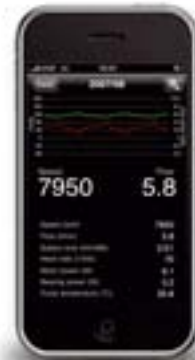
Patientendaten auf dem iPhone: Im Normalbetrieb meldet das Telematik-Modul Durchschnittswerte für Druck, Fluss, Drehzahl der Pumpe und andere Daten
